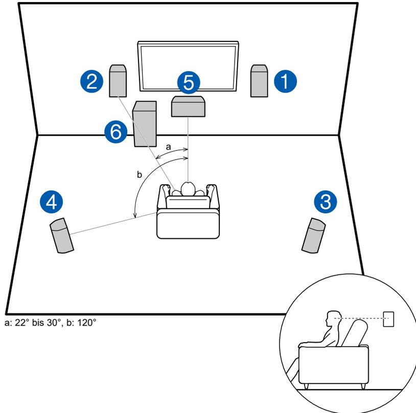
Dies ist ein grundlegendes 5.1-Kanalsystem. Über die Frontlautsprecher wird Front-Stereoklang ausgegeben, und ein Center-Lautsprecher gibt den Ton aus der Bildmitte wie Dialoge und Gesang aus. Die Surround-Lautsprecher erzeugen das hintere Klangfeld. Der Subwoofer gibt Bassklänge wieder und erzeugt das volle Klangfeld.
