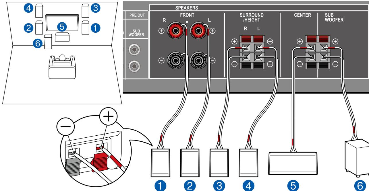
Dies ist eine Kombination aus dem 3.1-Kanalsystem und Front-Höhenlautsprechern. Ein Front-Höhenlautsprecher ist ein Typ vom Höhenlautsprecher. Sie können nur einen Satz von Höhenlautsprechern für den Anschluss unter den folgenden drei Typen auswählen.
