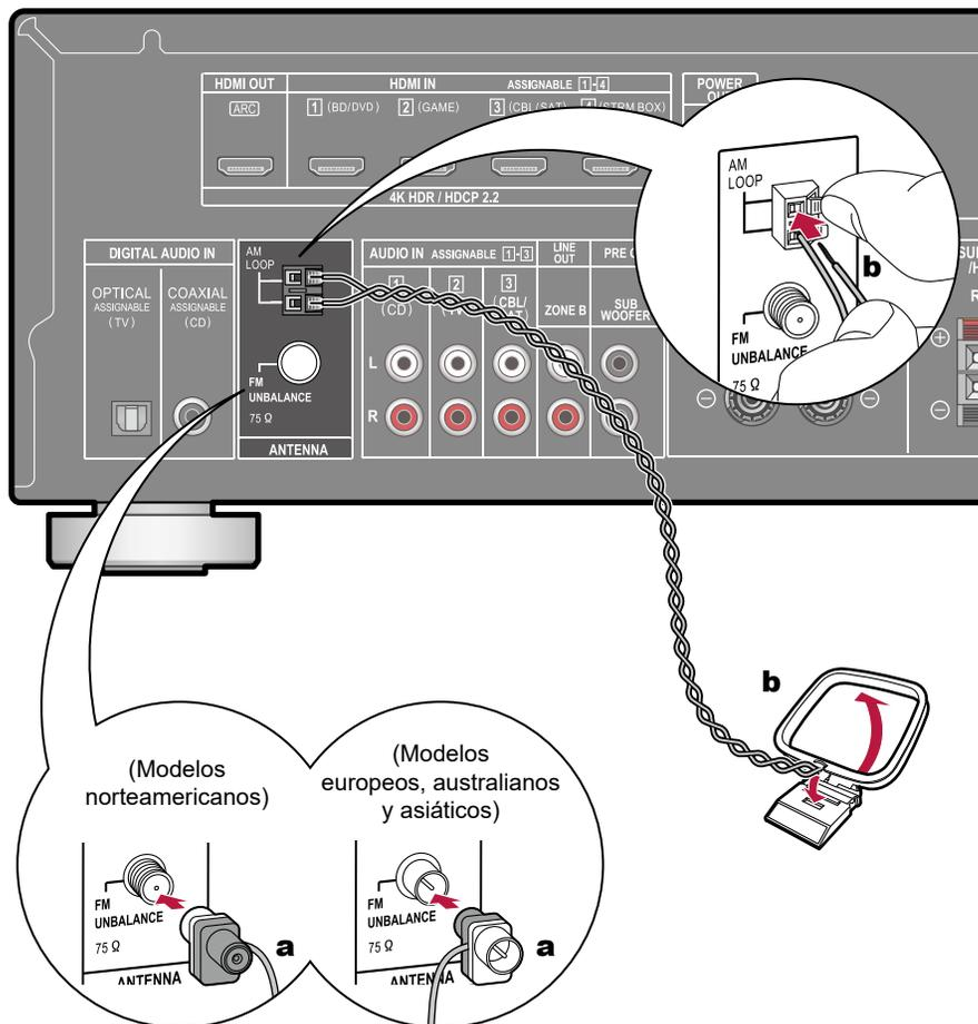
Conecte la antena a esta unidad y colóquela en una posición óptima para escuchar las señales de radio recibidas. Coloque la antena de FM para interiores en la pared con chinchetas o cinta adhesiva.
