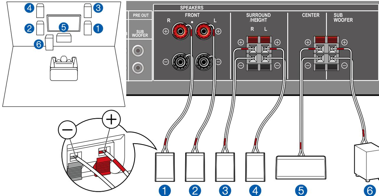
Esta es una combinación del sistema de canales 3.1 y altavoces altos delanteros. Un altavoz alto delantero es un tipo de altavoz de altura. Puede seleccionar únicamente un conjunto de altavoces de altura entre los siguientes tres tipos de conexión.
