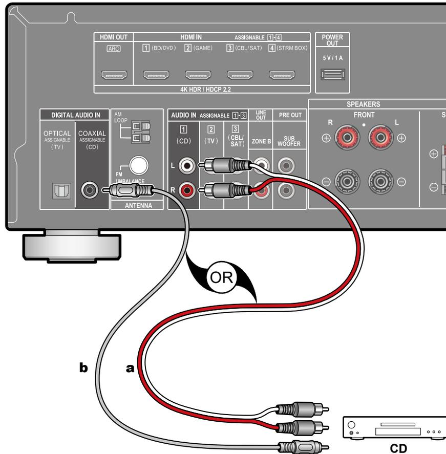
Este es un ejemplo de conexión de un componente de audio. Conecte un reproductor de CD utilizando un cable coaxial digital o un cable de audio analógico.
