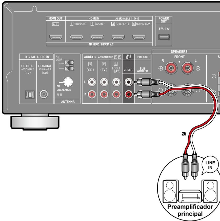
Mientras realiza la reproducción de la sala principal (ZONE A), puede disfrutar de 2 canales de audio de la misma fuente en la sala separada (ZONE B) al mismo tiempo. Utilice un cable analógico para conectar el conector ZONE B LINE OUT de esta unidad y el conector LINE IN del Preamplificador principal en la sala separada.
