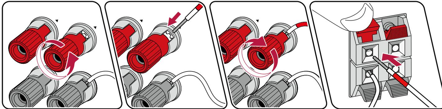
Conecte correctamente los conectores de la unidad y los del altavoz (lado + en lado + y lado - en lado -) para cada canal. Si la conexión es incorrecta, los bajos no se reproducirán adecuadamente debido a una fase inversa. Los hilos de la punta del cable del altavoz no sobresalen del terminal del altavoz al realizar la conexión. Si los cables expuestos tocan el panel trasero o los cables del lado + y el lado - se tocan entre sí, se puede producir un fallo de funcionamiento.
